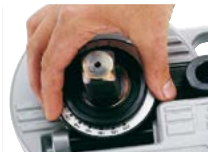
Ручная настройка угла гибки от 0 до 180°
