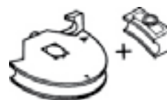
Состоит из сегментов из ковкого алюминия и соответствующего скользящего башмака (упора)
